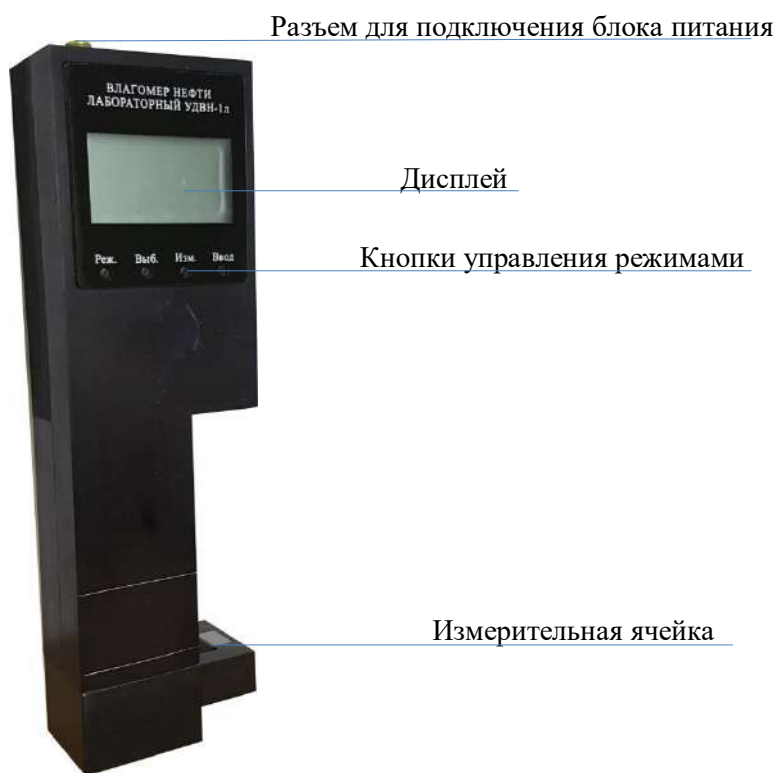
Рисунок 1 – Внешний вид влагомера нефти лабораторного УДВН-1л
